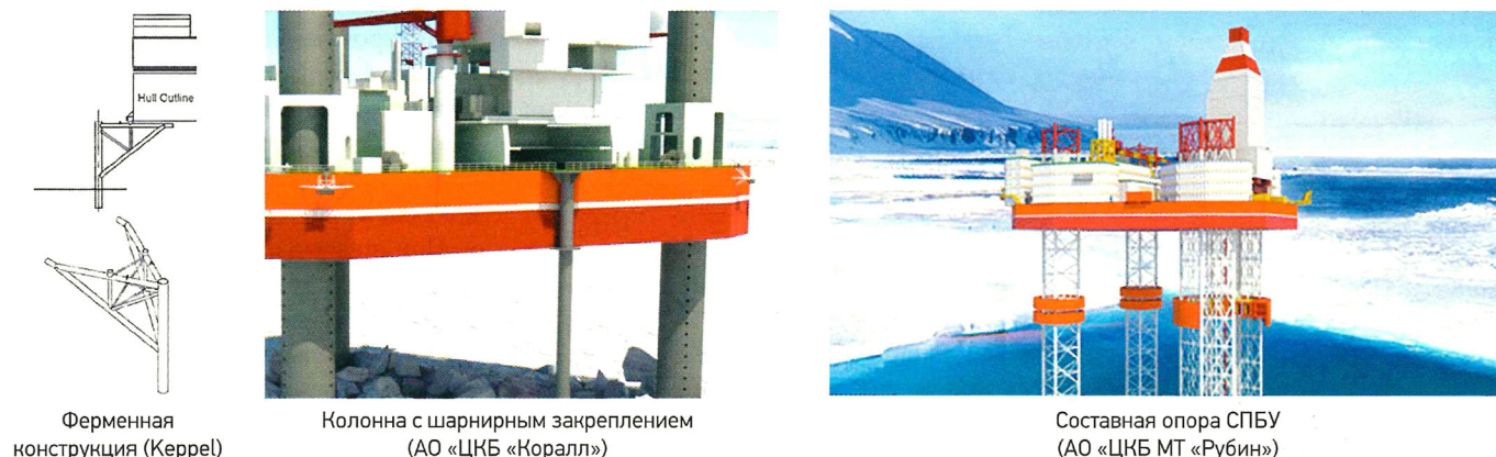
Рис. 1 Варианты организации пассивной защиты райзера от ледовых воздействий
