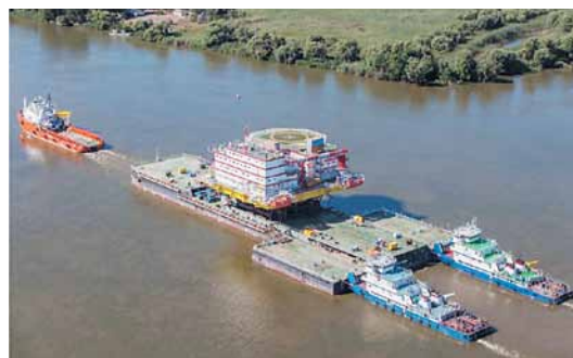
Рис. 16. Транспортно-монтажная баржа с размещенным на ней верхним строением платформы жилого модуля в процессе перехода к месту установки
