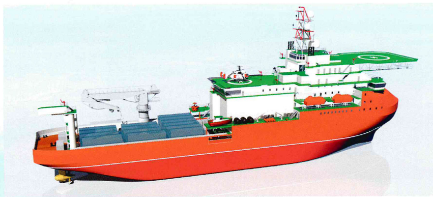
РИС. 11. Плавучая база по снабжению и обслуживанию морских буровых установок в арктических морях
