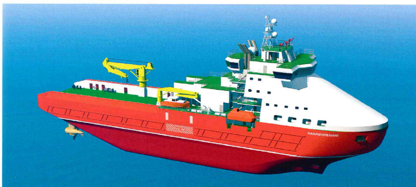
РИС. 10. Судно снабжения усиленного ледового класса
